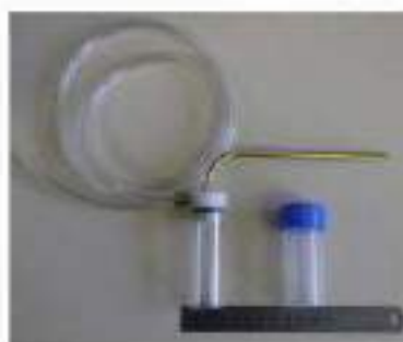
Figure 2 : aspirateur à bouché et tube de récolte (photo B. KAUFMANN)
